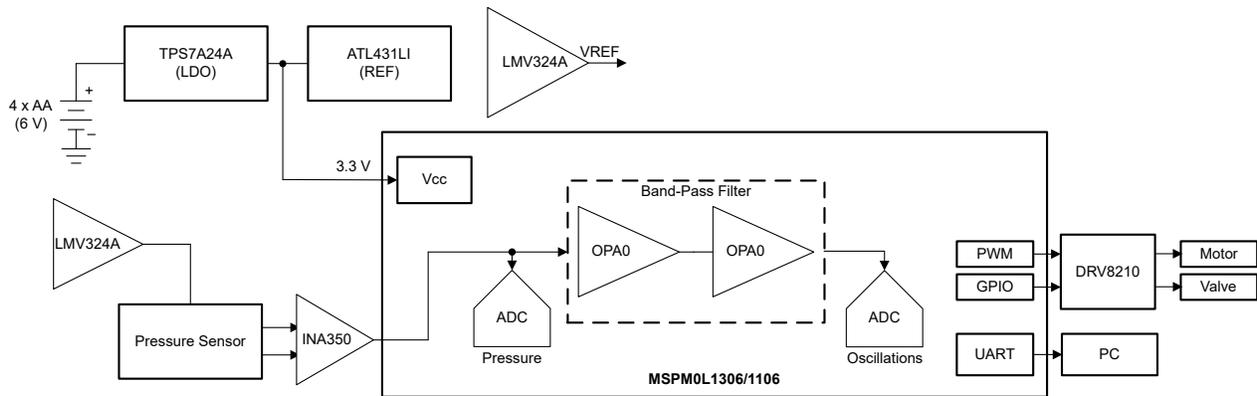
Figure 2-2. System Block Diagram B
