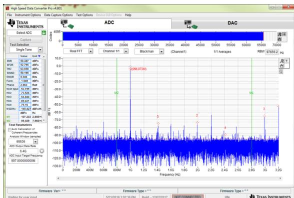
**Figure 28. ADC2 Spectrum 6.4 GSPS 95**
