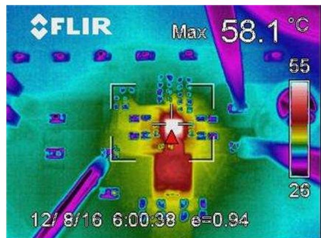
Figure 15. EVM IC Thermal Readout
