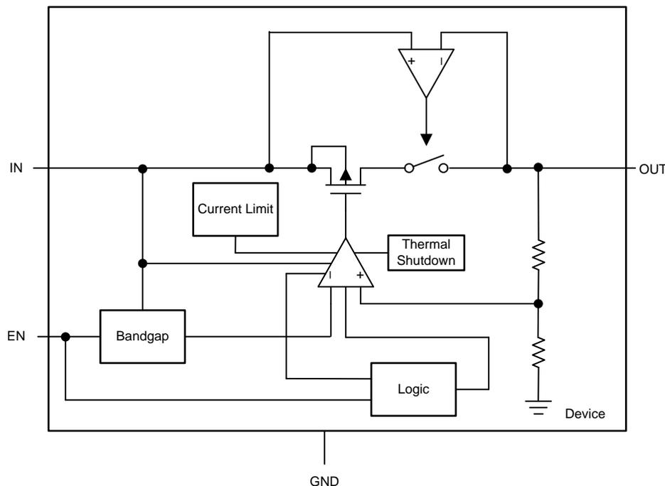
**Figure 2. TPS709-Q1 Block Diagram**
