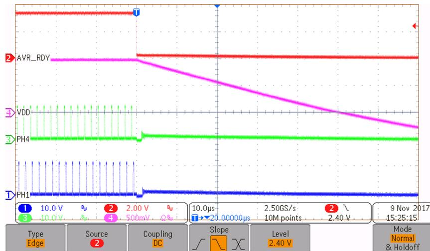
Figure 30. VDD Rail—60-A Shutdown
