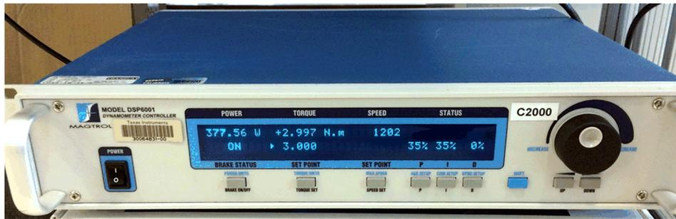
Figure 19. Dynamometer Controller
