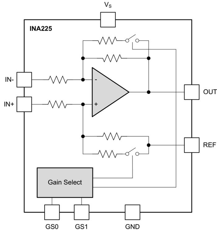
**Figure 4. INA225-Q1 Block Diagram**
