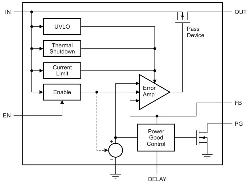
**Figure 5. TPS7A1601-Q1 Block Diagram**
