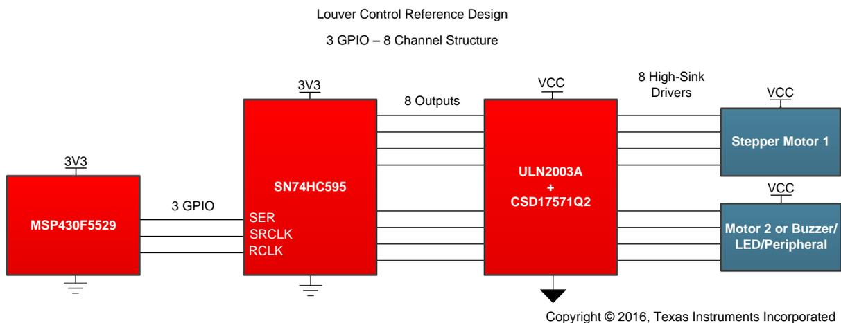
**Figure 1. Block Diagram**
