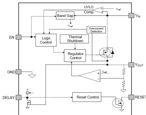
**Figure 4. TPS7B6733-Q1 Block Diagram**
