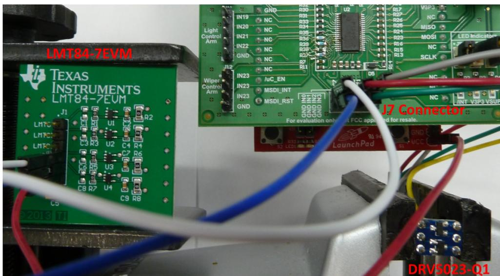
Figure 27. J7 Input Header
