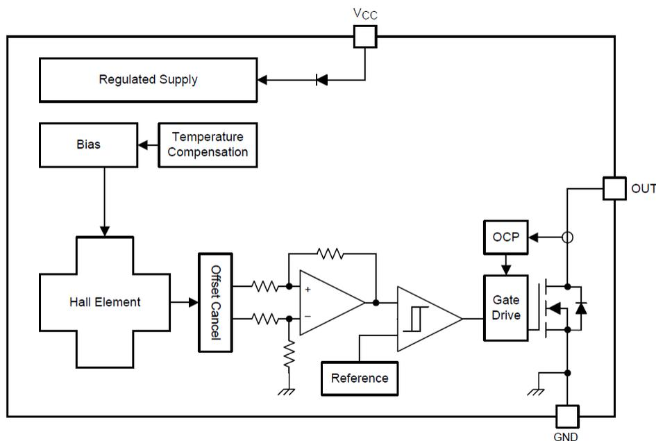
**Figure 5. DRV5023-Q1 Block Diagram**
