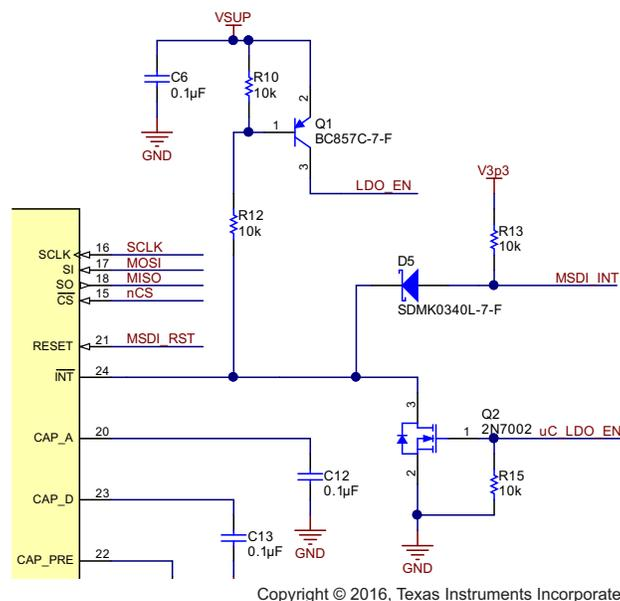
Figure 10. TPS7B6733-Q1 EN Control Circuitry
