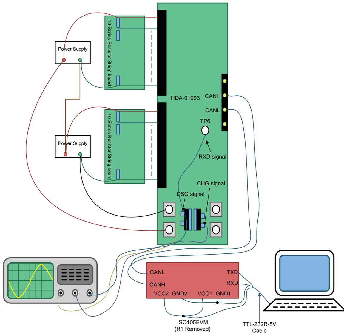
**Figure 16. UART Test Diagram**
