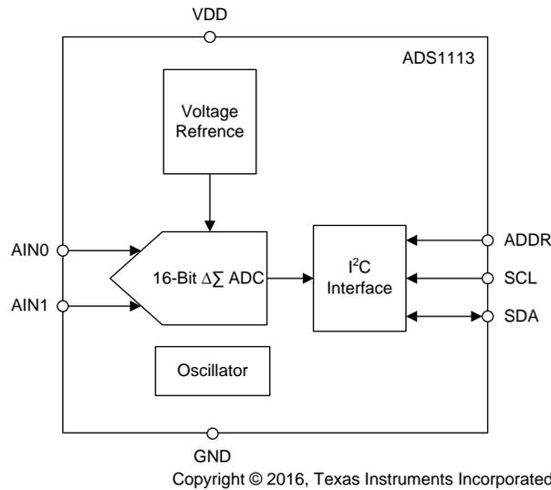
**Figure 4. ADS1113 Block Diagram**
