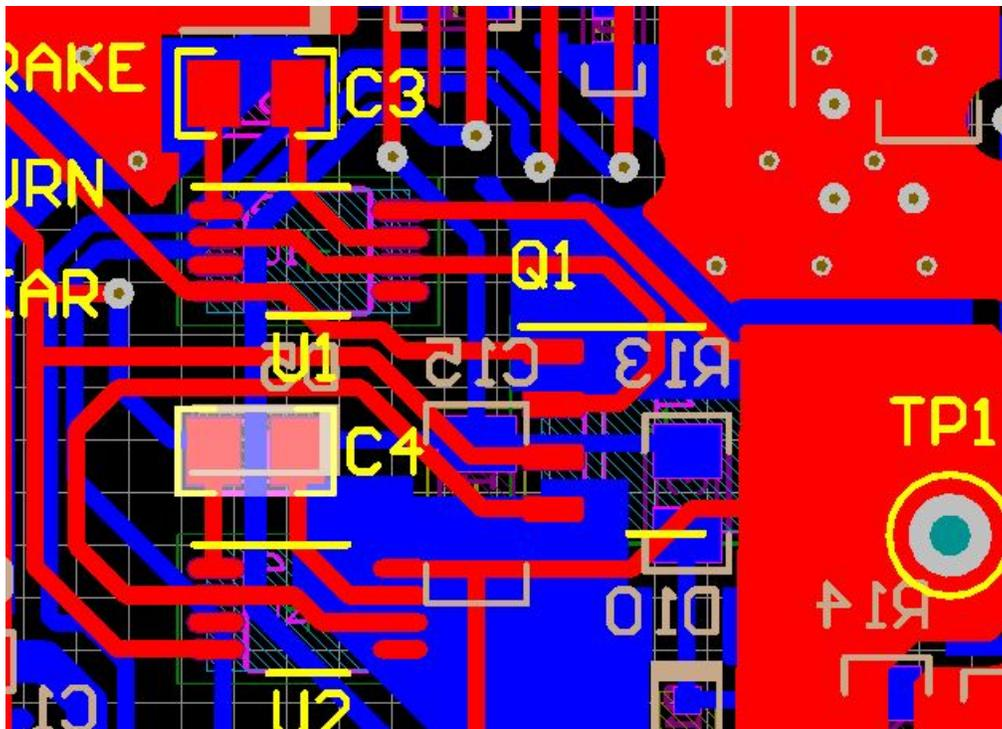
**Figure 49. LM74610-Q1 Smart-Reverse Battery-Diode Layout**
