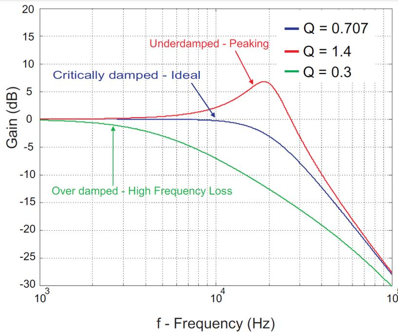
Figure 7. Filter Damping (Q Factor)
