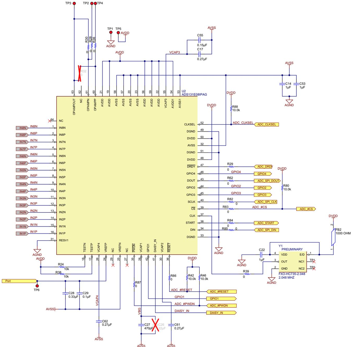
Figure 2. ADS131E08S Configuration
