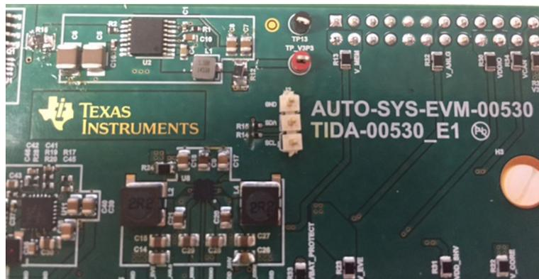
**Figure 14. I<sup>2</sup>C Header**
