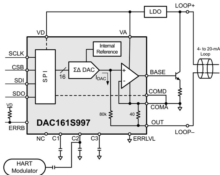
**Figure 2. DAC161S997 Block Diagram**
