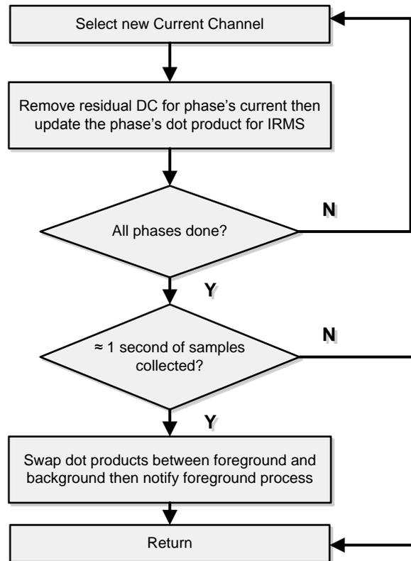
**Figure 25. Per\_sample\_dsp() Function**
