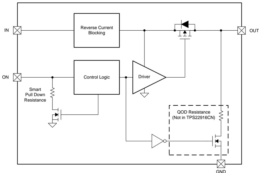
**Figure 1. TPS22916B Block Diagram**
