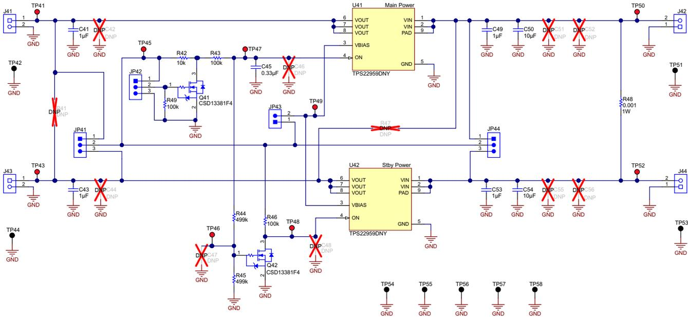
Figure 16. Make-Before-Break 2:1 Power MUX Schematic
