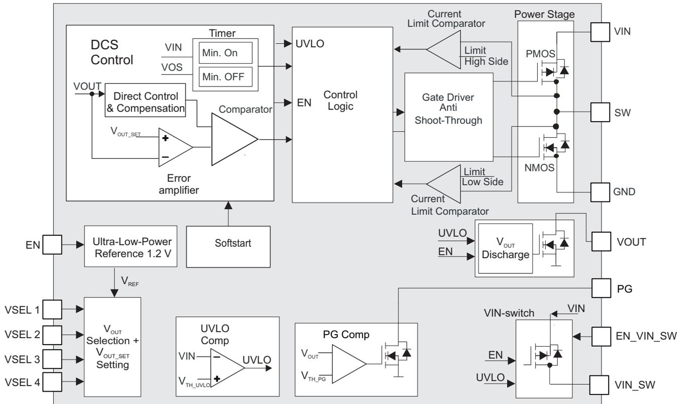
**Figure 3. TPS62745 Block Diagram**
