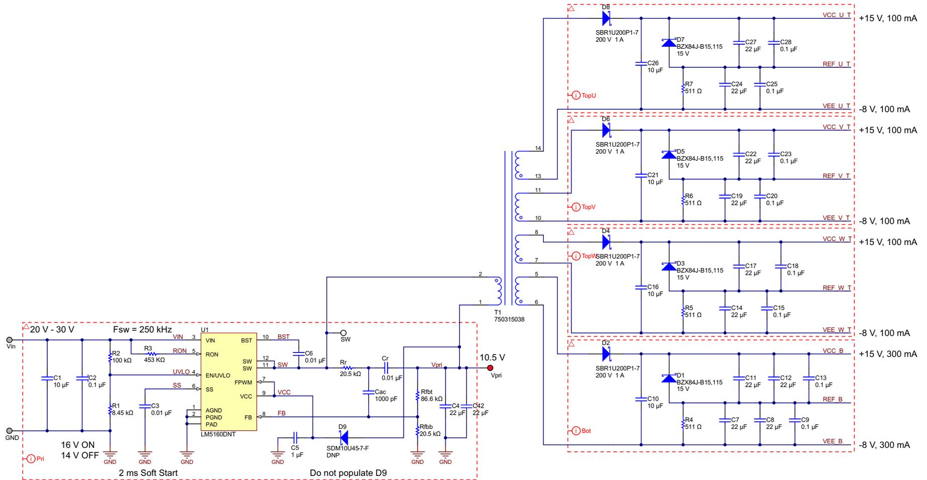
Figure 27. TIDA-00199 Schematic
