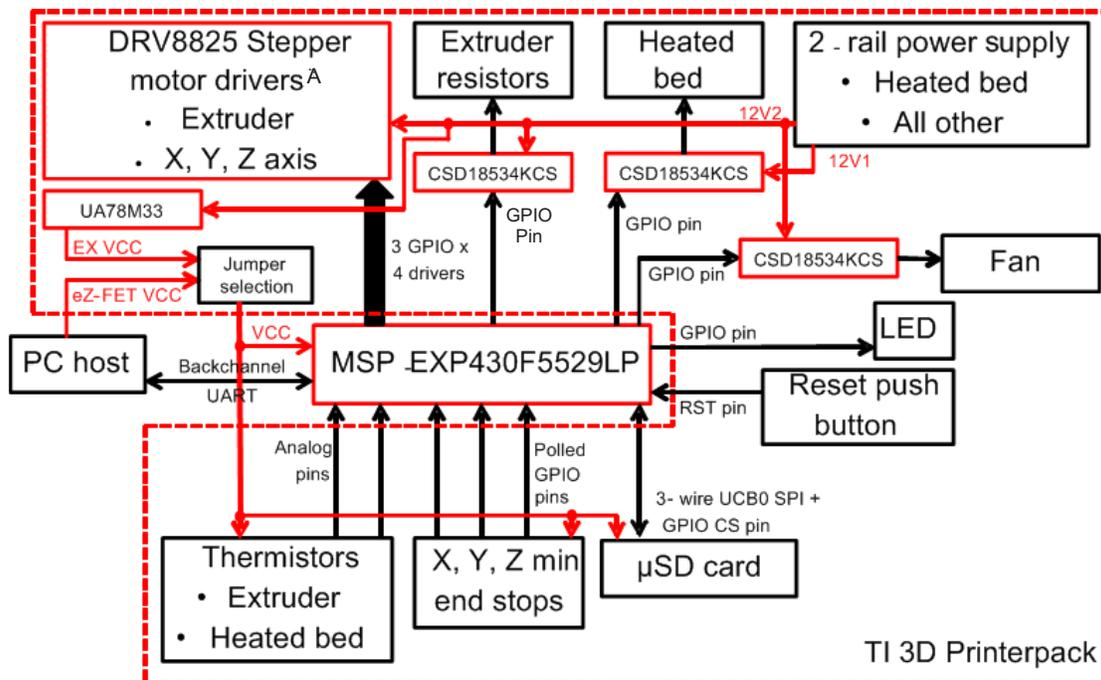
**Figure 2. 3D Printerpack Block Diagram**
