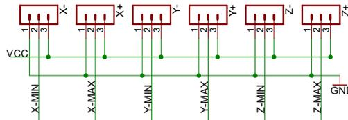
Figure 23. Endstops Schematic
