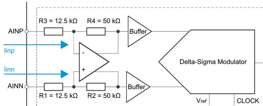
Figure 25. AMC1304 Input Amplifier
