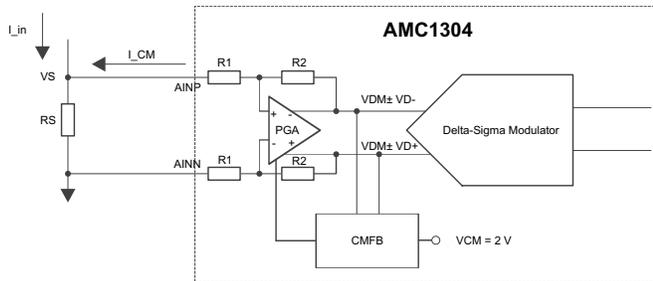
Figure 23. AMC1304 Input Block Diagram
