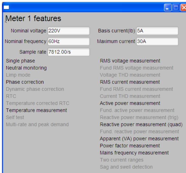
**Figure 42. Meter Features Window**
