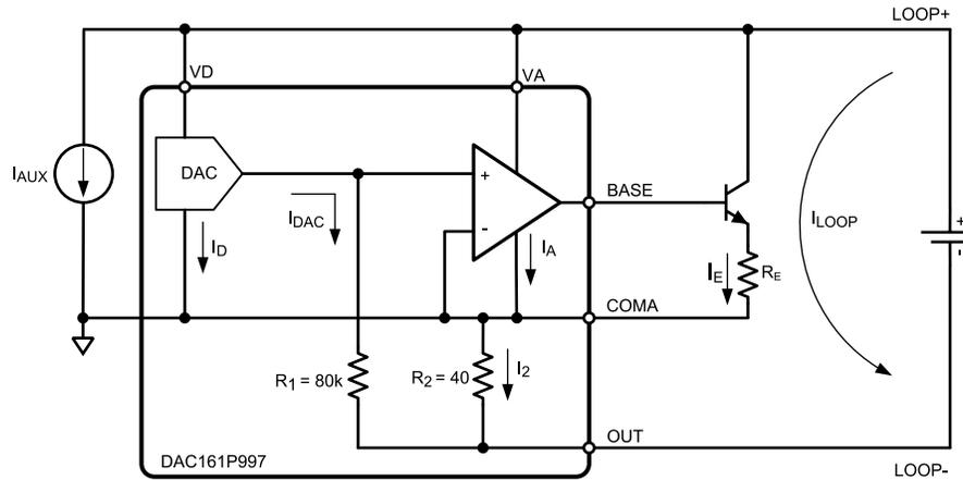
**Figure 27. DAC161P997 Block Diagram**
