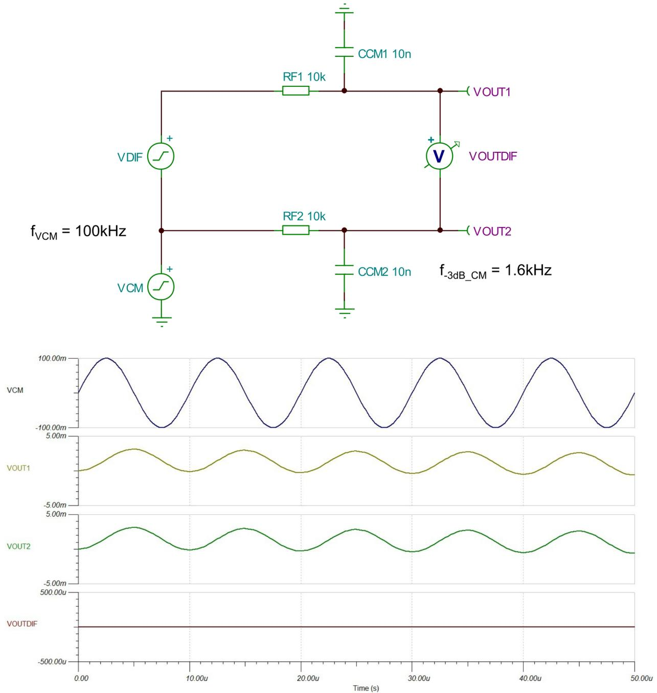
Figure 29. Common-Mode Filter Ideal Matching
