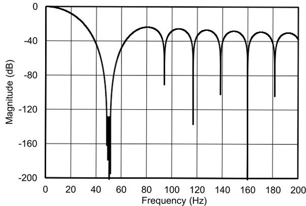
Figure 36. ADS1220 Digital Filter Response
