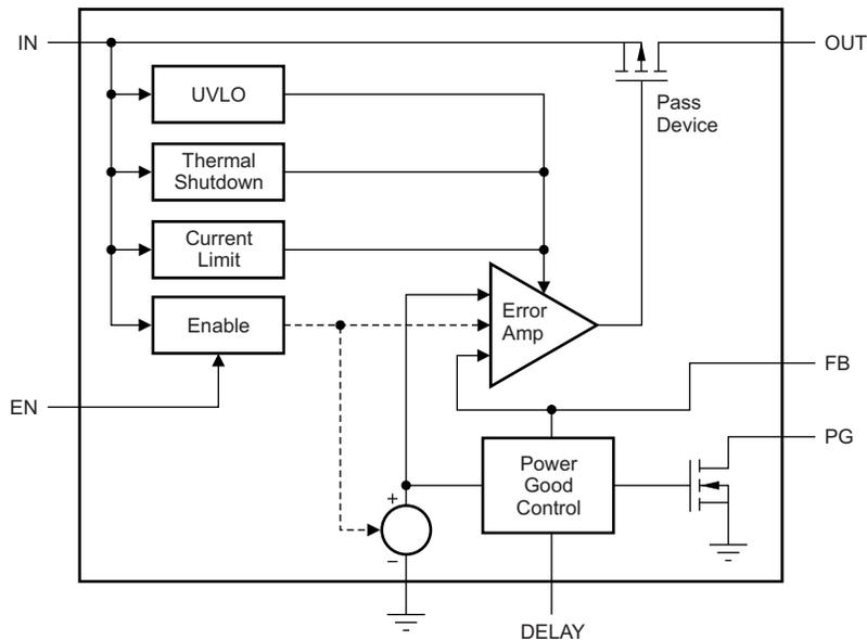
**Figure 21. TPS7A1601 Block Diagram**
