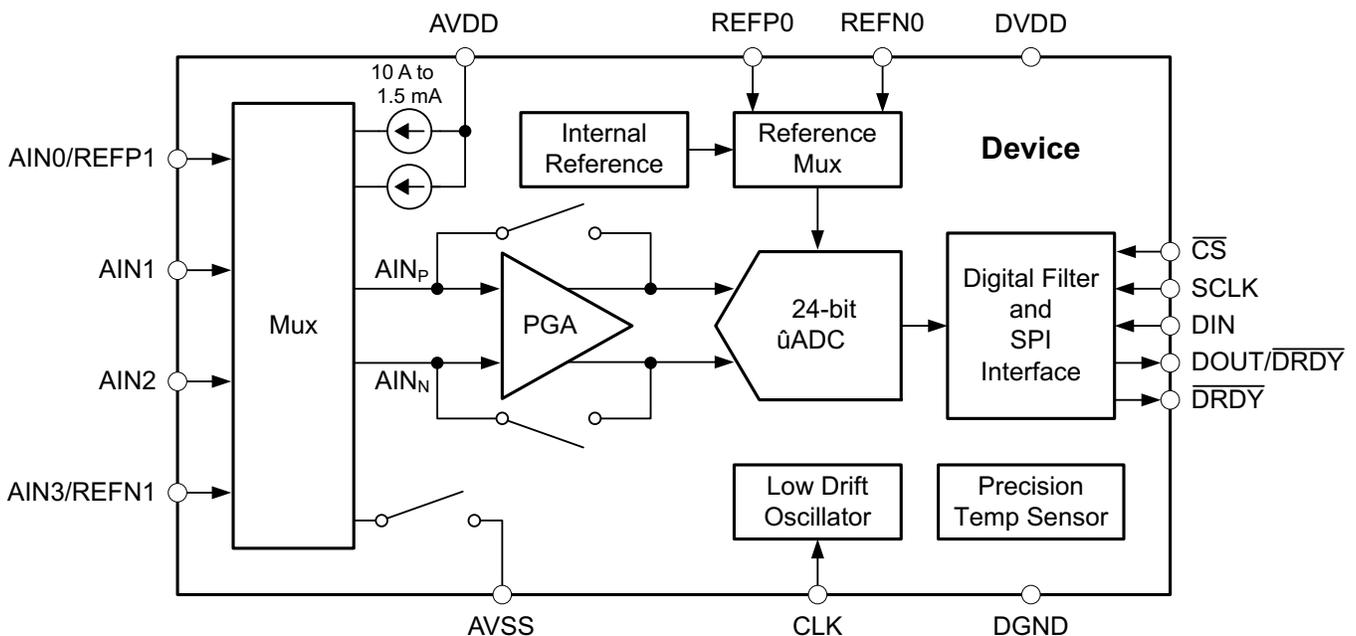
**Figure 19. ADS1220 Block Diagram**
