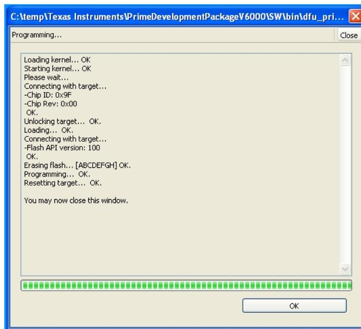
**Figure 5. Flashing G3-PLC Firmware (via XDS100)**
