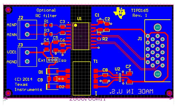
Figure 22. AMC1304 PCB Layout
