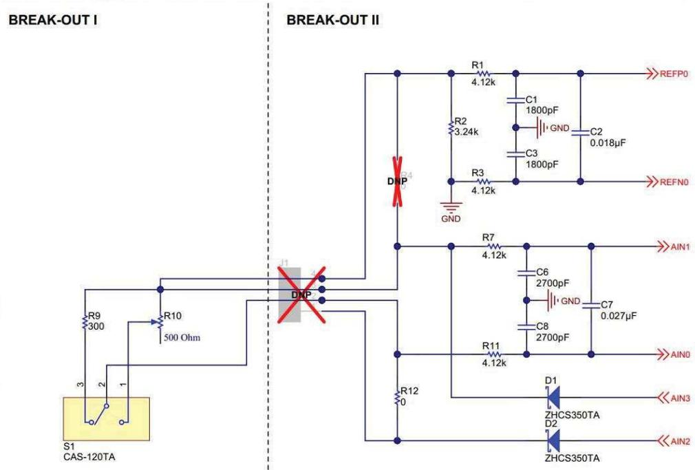
Figure 20. Analog Front-End Schematics
