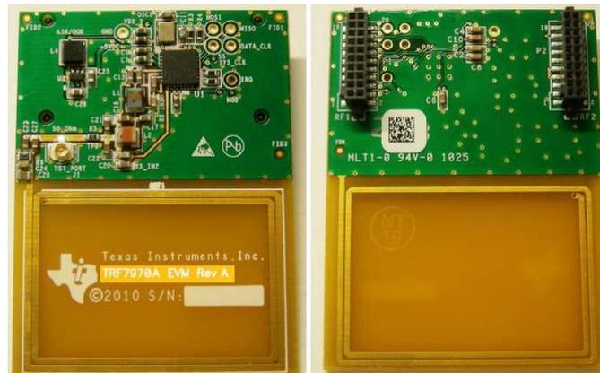
**Figure 16. RFID Module**
