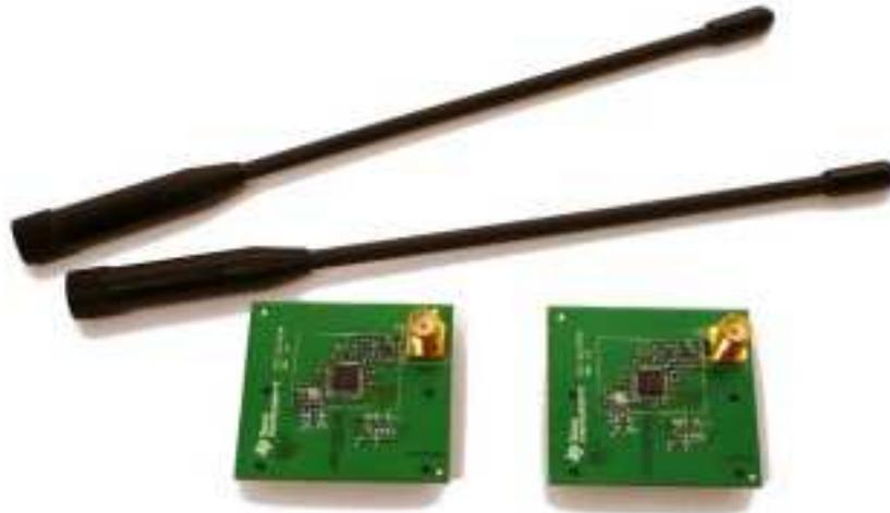
**Figure 12. Sub-1GHz Radio**
