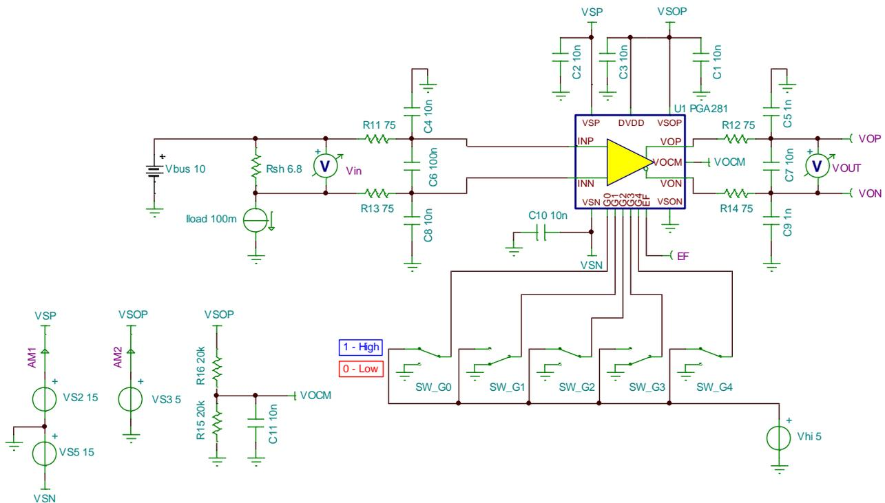
**Figure 5: TINA-TI™ Schematic**
