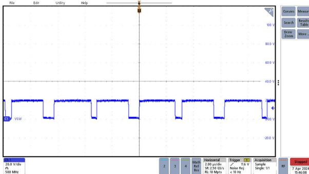
**Figure 3-9. Buck Mode Switching Node Waveform**
