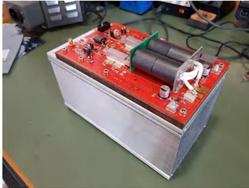
heat sink, for fan 120 mm × 120 mm
