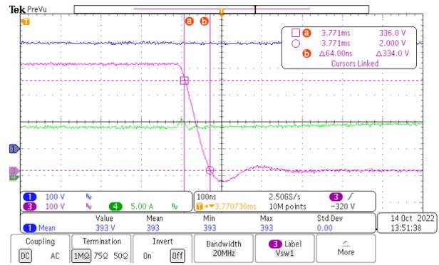
CH1: VBUS, CH3: VDS, CH4: Inductor Current
