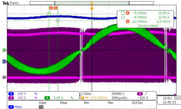
CH1: VBUS, CH3: VDS, CH4: Inductor Current
