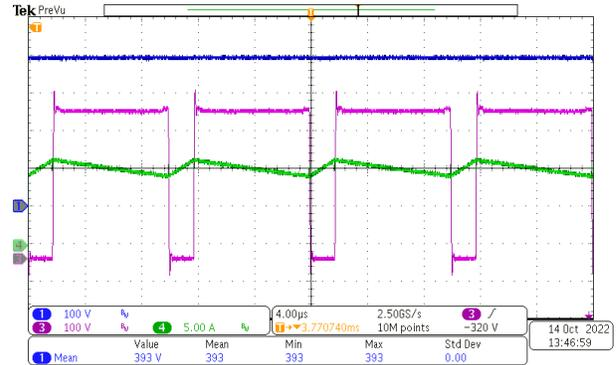
CH1: VBUS, CH3: VDS, CH4: Inductor Current
