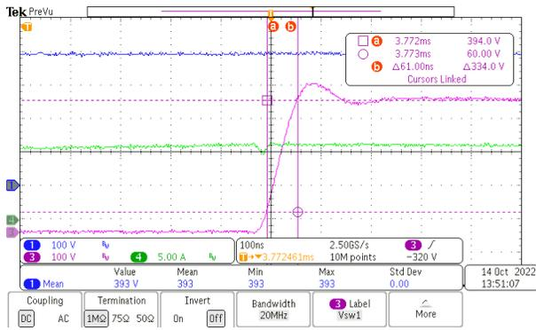
CH1: VBUS, CH3: VDS, CH4: Inductor Current
