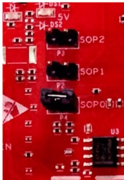
**Figure 13. SOP Jumpers**
