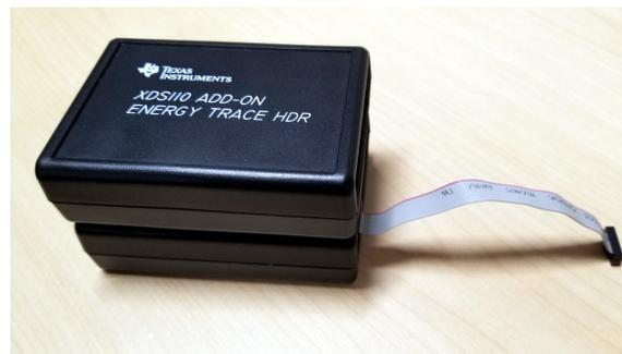
Figure 19. XDS110 Probe and ETHDR System
