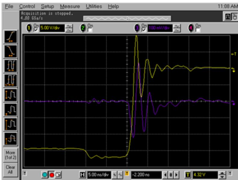
**Figure 9. GaN Qrr Measurements**
