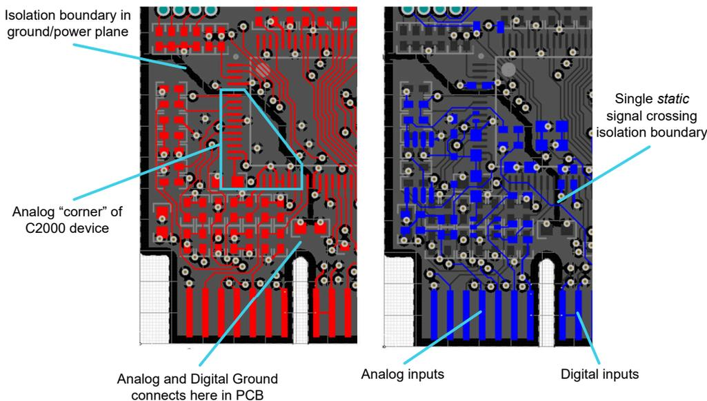
**Figure 4-9. Analog/Digital Isolation**
