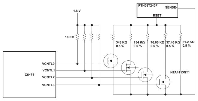
Figure 19. TI SmartReflex System Solution
