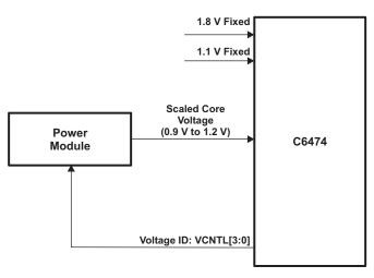
Figure 18. SmartReflex Operation
