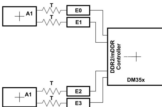
**Figure 7. DQS and DQ Routing and Topology**
