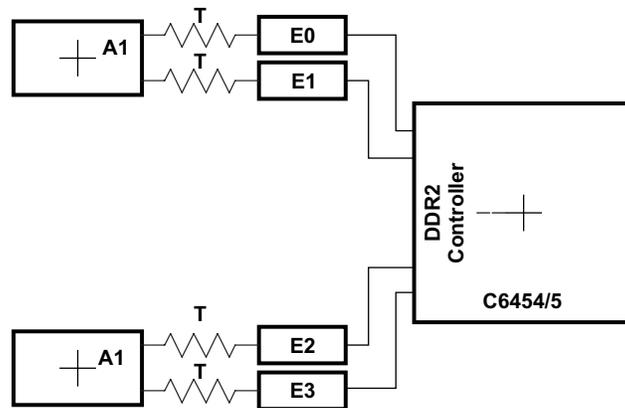
**Figure 7. DQS and DQ Routing and Topology**
