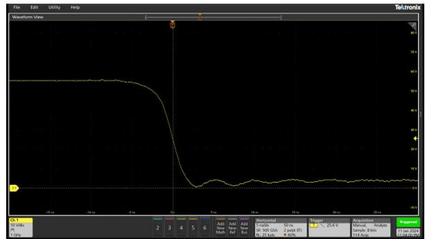
Figure 3-6. SW Node Low-Side Turn-On
