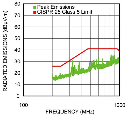
**Figure 21. 200 MHz-1000 MHz Horizontal 650 mA Load**
