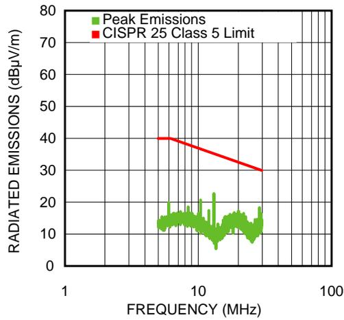
**Figure 15. 5 MHz-30 MHz 650 mA Load**
