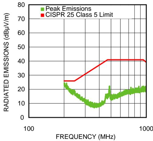
**Figure 20. 200 MHz-1000 MHz Horizontal 1A Load**
