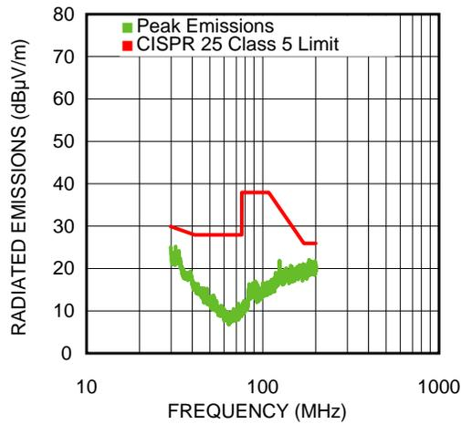
**Figure 17. 30 MHz-200 MHz Horizontal 650 mA Load**
