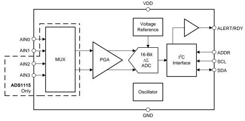
Figure 7. ADS1115 Block Diagram
