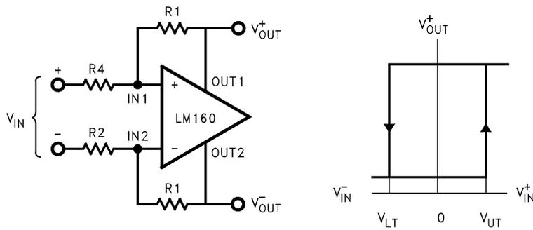
$$V_{UT} = V_{OH} \left( \frac{R_2}{R_1} \right) - V_{OL} \left( \frac{R_4}{R_3} \right)$$
