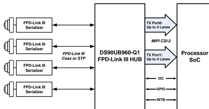
Figure 2. DS90UB960-Q1 System Diagram
