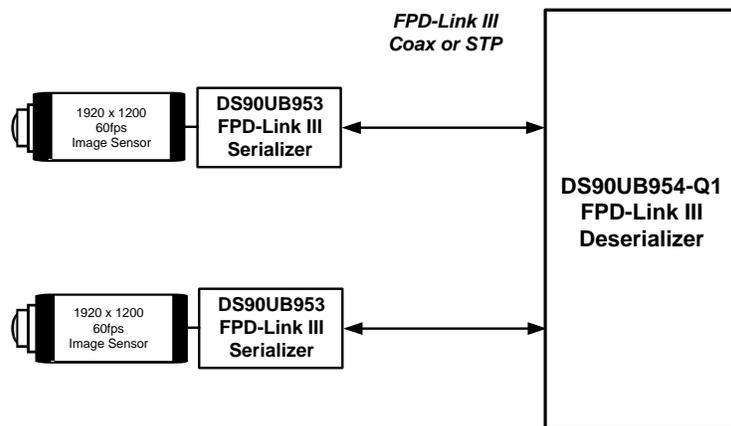
Figure 1. DS90UB954-Q1 System Diagram
