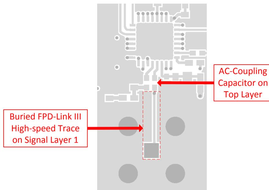
**Figure 10. DS90UB953-Q1 Serializer DOUT+ Trace Layout**
