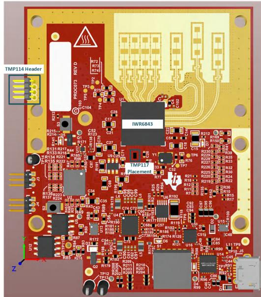
Figure 4-6. IWR6843ISK Evaluation Module
