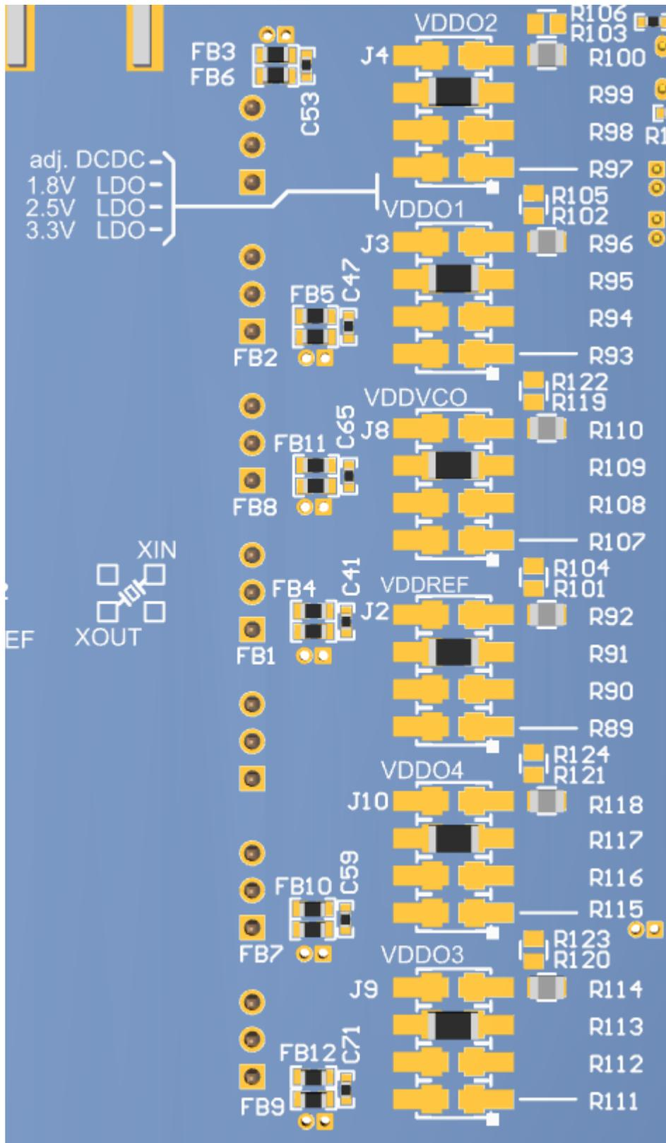
Figure 2-5. Evaluation Module Default, Power Distribution
