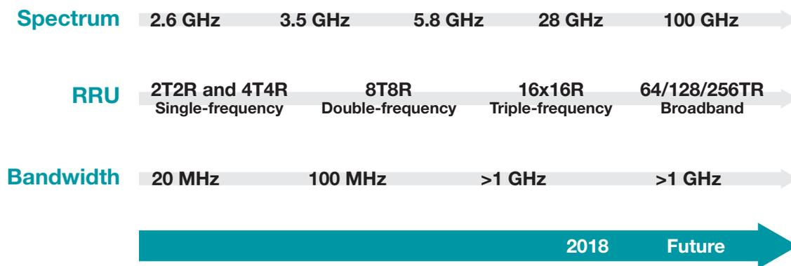
**Figure 4:** Radio parameters evolution.
