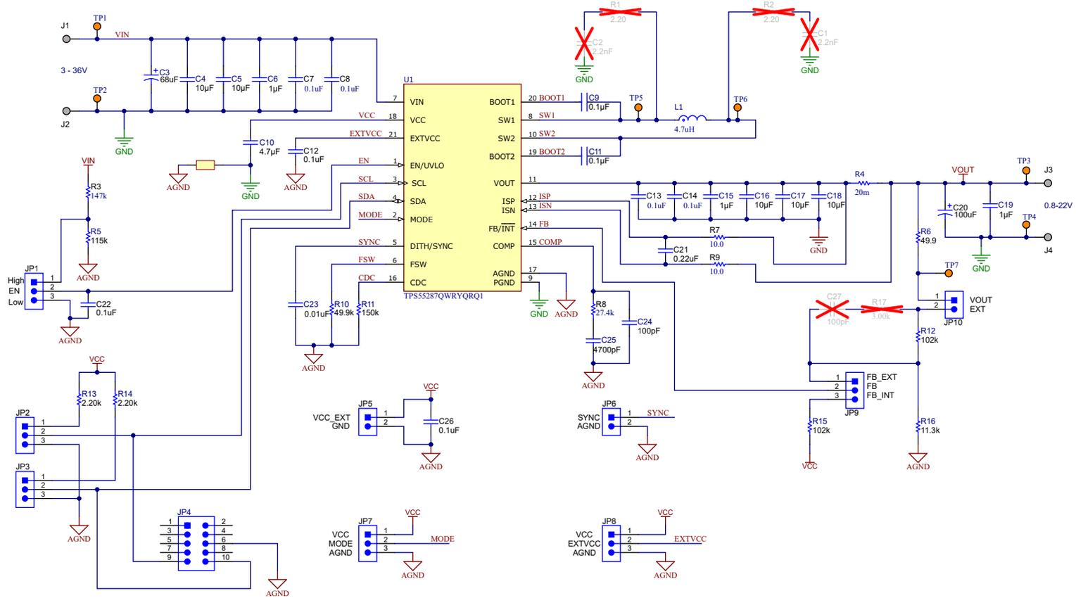
Figure 4-1. TPS55287Q1EVM-085 Schematic
